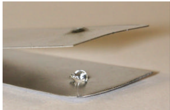
Abb.7 Stiel mit Seitenschneider abkneifen, Linse zwischen Blechschenkel legen, Bruchstelle seitlich orientieren.
