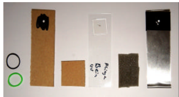
Abb.12 Die Komponenten des Mikroskops in der Reihenfolge des Zusammenbaus - Objektiv, Objekt und Beleuchtungs-Aperturblende auf einer Achse
