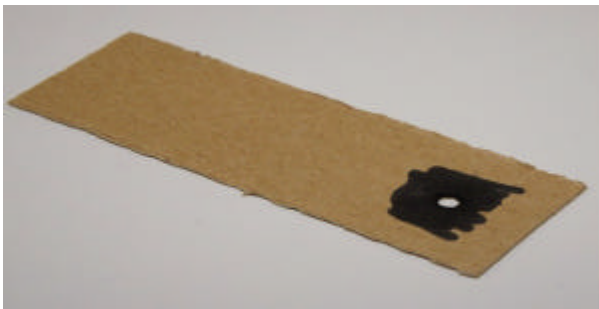
Abb.11 Pappstreifen in Objektträgergröße mit ca. 2,5mm-Loch versehen und mit Edding schwärzen, er stellt die Beleuchtungs-Aperturblende dar.
