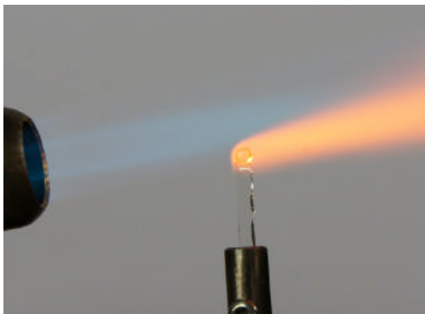
Abb 5. Kugellinse unter stetem Drehen erschmelzen, Soll-Durchmesser ca. 1,5 – 4 mm
