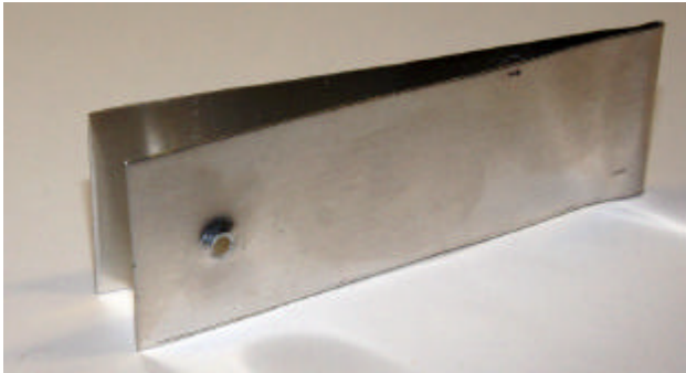
Abb. 4. Die nach innen zeigenden Auswölbungen mit der Flachzange einebnen und mit dem Körner oder dergleichen nach außen auswölben (Kugellinse soll beidseitig gehalten werden).
